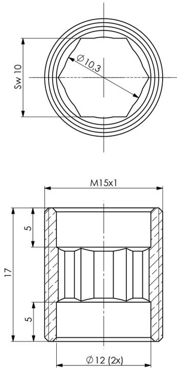
**[Gewindenippel M15x1 - L 17 mm Messing passend zu Schlauchteile mit M15 IG](#)**
